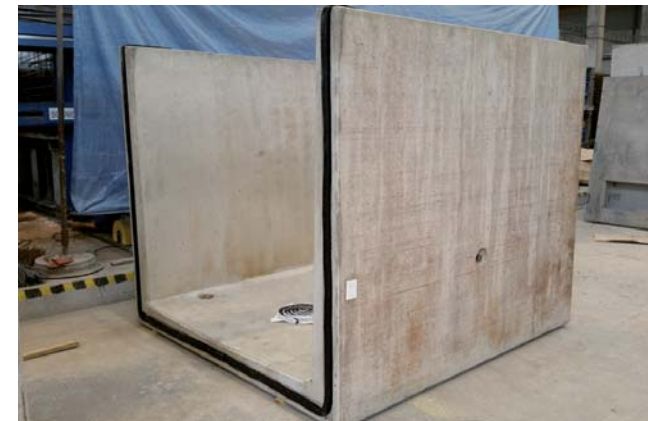
3 / Vlepuje se do drážek svislých stěn i dna kanálu.
