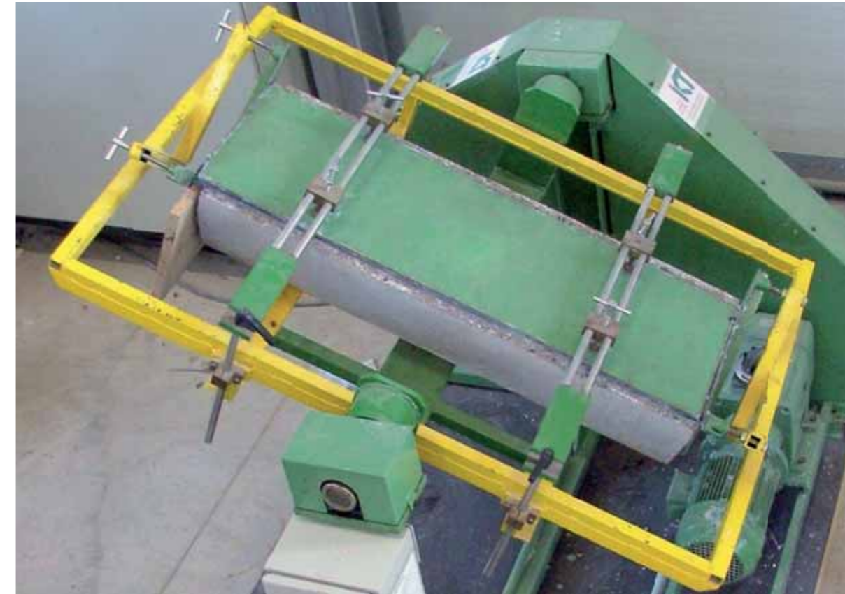
Tzv. „darmštatský žlab“ pro zkoušení odolnosti proti otěru.
